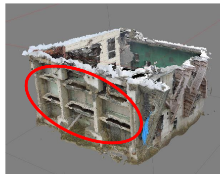
地上写真を用いて構築した3次元建物モデル
