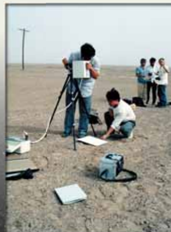
リモートセンシングデータを用いて導いた解析結果と地表あるいは地表付近で収集された情報の間で、正確さや整合性をチェックする作業をグランドトゥースといいます。
